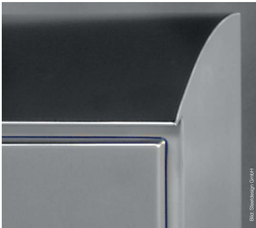
Bild 2 | Der flussoptimale Neigungswinkel von 30° beim Korpusdach vermeidet das Festsetzen von Schmutz und verhindert das Abstellen von Gegenständen.
